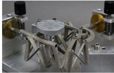
Fig. 9. Sistema de posicionamiento de propulsor, diseño realizado para la NASA [20].
