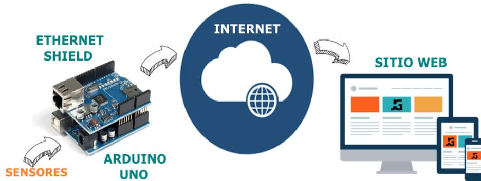
Fig. 1. Diagrama del diseño del sistema.
